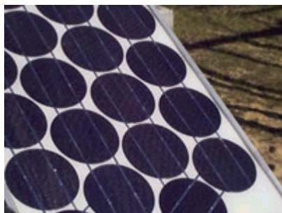
Células mono-cristalinas num painel
