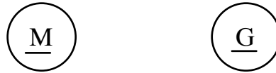
a) Símbolos de um motor e de um gerador de corrente contínua.
