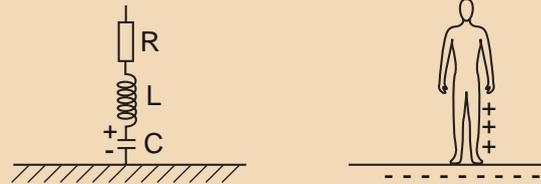
**En el momento de la descarga electrostática R,L,C del circuito de descarga los que determinan las características: tiempo de subida, duración, valor de pico...**
