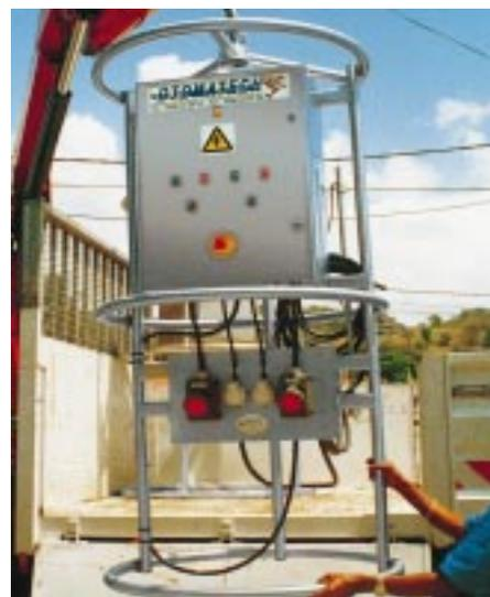
Protección específica contra los choques en armarios móviles
