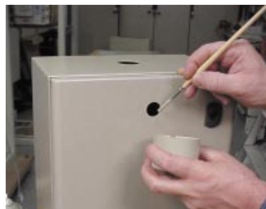
**Retoque manual de los bordes de chapa al descubierto: recomendada para una utilización posterior en medio húmedo o corrosivo**
