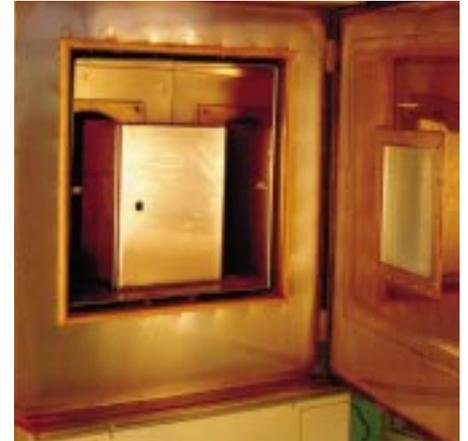
Ensayo en recinto climático que permite recrear las condiciones de humedad y de condensación
