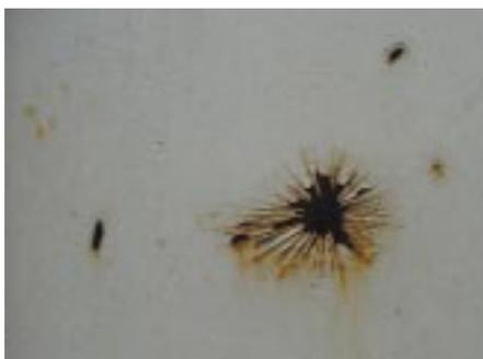
**Desprendimiento radial de la película de pintura a raíz de un choque**
