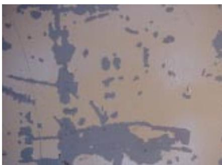
**Desprendimiento de la pintura de acabado debido a una incompatibilidad entre las capas**
