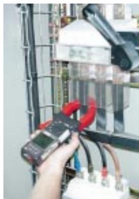
**La medida de los armónicos es muy fácil de realizar con los aparatos actuales. No es necesario desmontar ni interrumpir. Cada circuito puede ser testeado individualmente. Se cuantifica cada fila de armónico en valor absoluto (en A) y en valor relativo (en %)**
