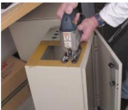
Recorte de una caja Atlantic con la sierra de corte vertical con protección previa por pegamento
