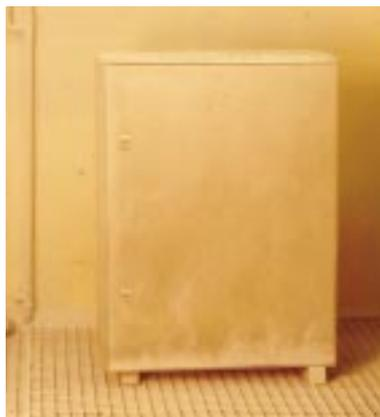
Ensayo de penetración de sólidos: en este caso, ensayo al polvo de talco
