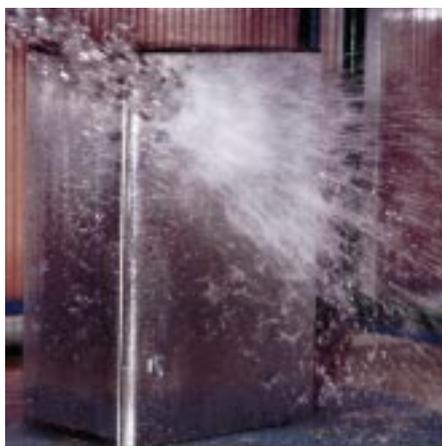
Ensayo de protección contra proyecciones de agua IP x 6
