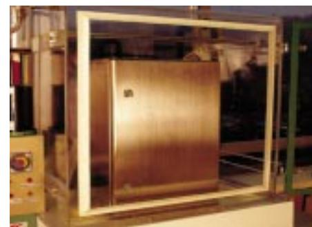
Simulación de la exposición en atmósfera industrial en un calefactor de SO<sub>2</sub> (dióxido de azufre)
