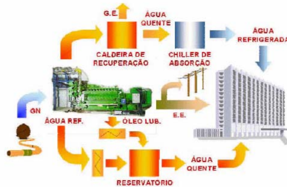
Figura 2 – Esquema de princípio de um sistema de trigeração [Brandao]
