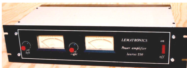
Amplificador com traseira em dissipador U até 2 x150W/8, 1987
