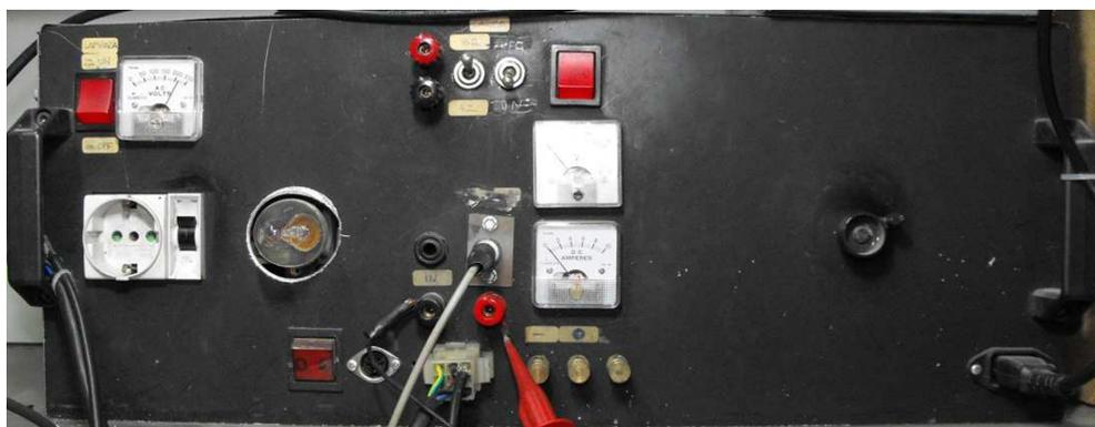
Imagem 6.2 - Aparelho de teste de amplificadores
