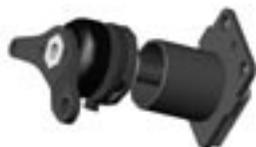
O travão de estacionamento pode ser calibrado manualmente para assegurar uma potência de travagem adequada no seu curto trajecto. O parafuso com mola de re-ajuste na ponta do travão é utilizado para regular adequadamente todo o mecanismo de ajuste.
