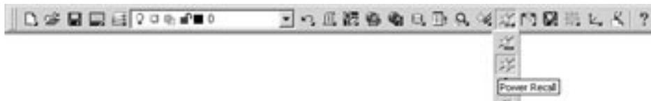
Utilize o comando Super Chamada (**Power Recall**) para invocar directamente um comando que tenha sido utilizado para criar um elemento específico num desenho. Se num desenho tiver seleccionado um rolamento, o comando Rolamento (Bearing) é activado. Não é necessário ter já utilizado este comando na sessão actual; basta que o objecto exista no desenho. Assim, não é necessário ter de procurar comandos específicos no menu, especialmente quando começar a trabalhar com a aplicação.
