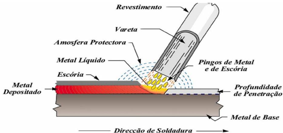
Fig. 79 - soldadura a ER. Fonte - ISQ
