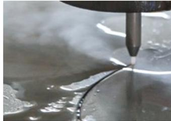
Fig. 59 – Corte a jato de água, fonte - [www.lasindustria.pt/corte-a-jato-de-agua](http://www.lasindustria.pt/corte-a-jato-de-agua)
