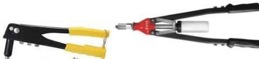
Fig. 75 e 76 - Rebitadeira manual e de tesoura
