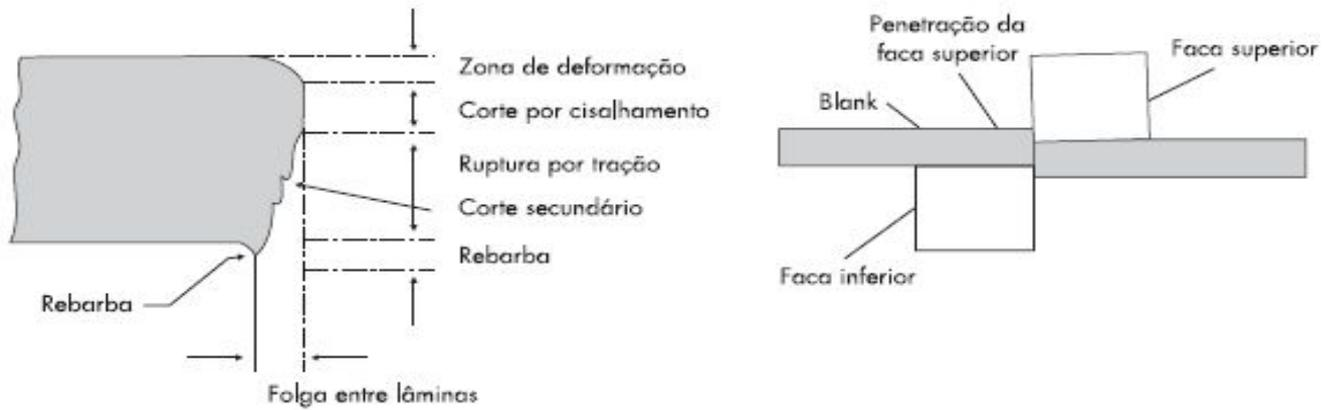
Fig. 38 - Imagem do topo cortado e do corte ao ser efetuado
