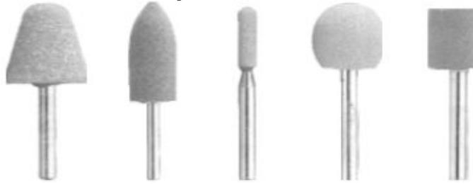
Fig. 121 - alguns tipos de mós usadas, fonte - CENFIM
