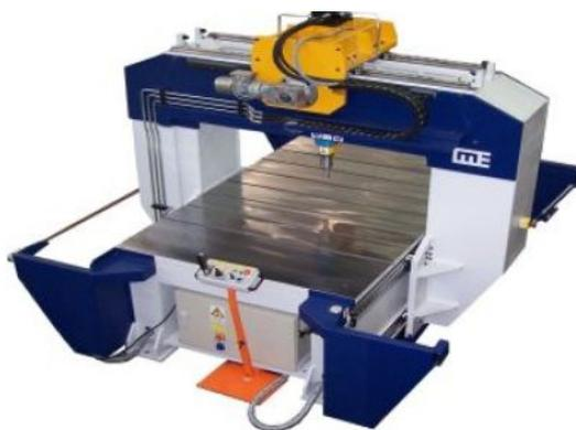
Fig. 117 - Prensa de endireitamento, fonte - Tiago Soares
