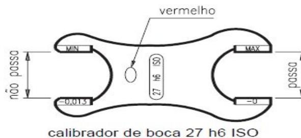
Fig. 124 - Calibrador de boca, fonte - Adriano Secco
