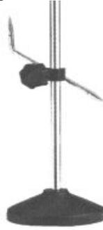
Fig. 31 - Graminho simples - utilizado na traçagem em diversas situações.
