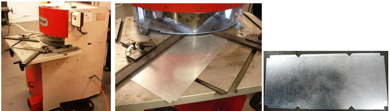
Fig. 42 e 43 - Máquina de corte de cantos da *Stilcrum*, ESAB. Fig. 44 - chapa cortada
