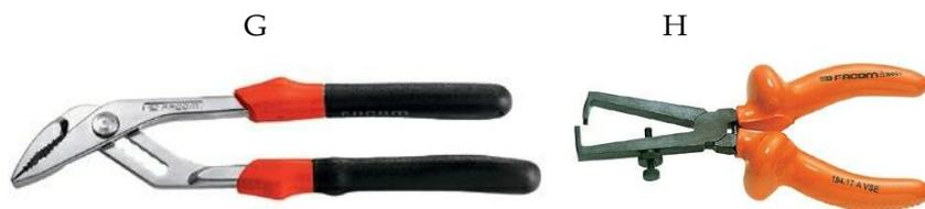
Fig. 2G - Alicate ajustável ou extensível; Fig. 2H - Alicate de descarnar fios.
