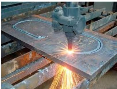
Fig. 56 - OxiCorte, fonte - [www.acoliga.com/oxicorte](http://www.acoliga.com/oxicorte)
