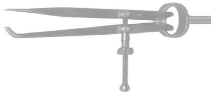
Fig. 29 - Compasso de perna e bico - utilizado na traçagem de paralelas.
