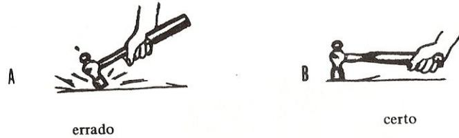
Fig. 17 - Maneira errada (A) e certa (B) de como empunhar o martelo ao bater.
