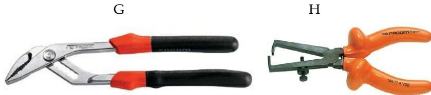
Fig. 2G - Alicates ajustável ou extensível; Fig. 2H - Alicates de descarnar fios.
