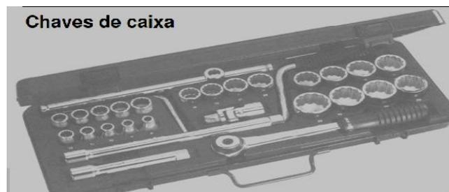
Fig. 87 - Chaves de caixa de 1/2", fonte - IESC, DEM
