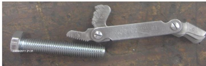
Fig. 65- Escantilhão de roscas para medir passo de rosca de parafuso
