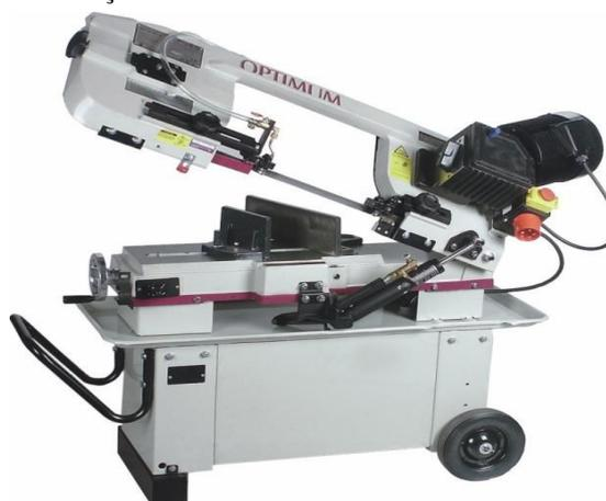
Fig 43 – Serrote de fita (horizontal) marca *Optimum*
