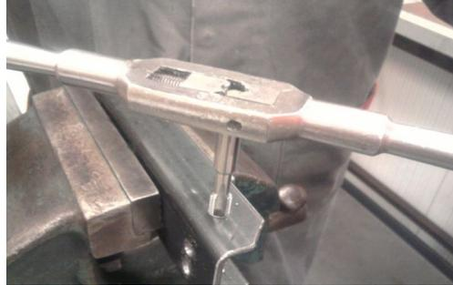
Fig. 69 - Abertura da rosca com ajuda de um macho de 8mm, fonte - alunos de EFA da ESAB
