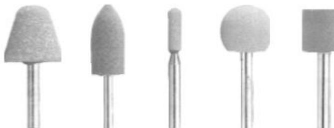
Fig. 81 - alguns tipos de mós usadas, fonte - CENFIM
