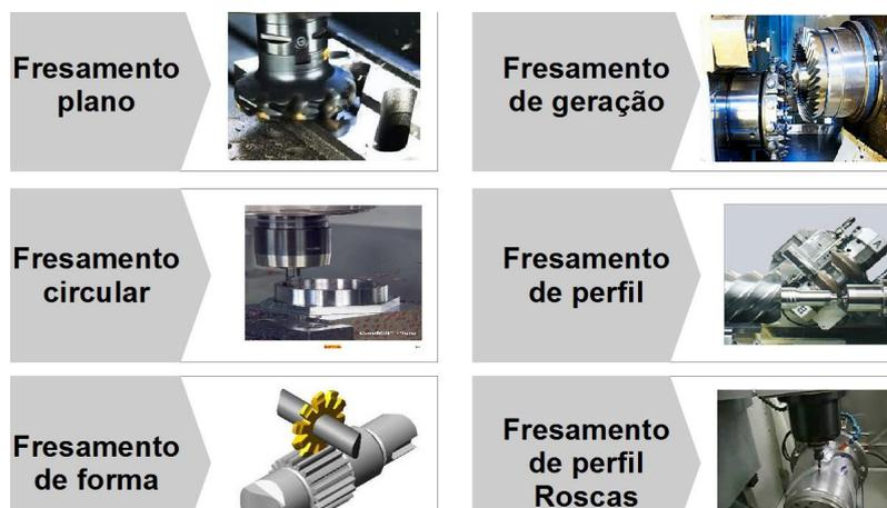
Imagem 2.31 - Divisão do processo de fresamento - DIN 8589, fonte - Rodrigo Stoeterau
