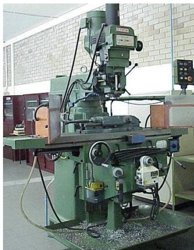
Imagem 2.4 - Fresadora vertical do IPB
