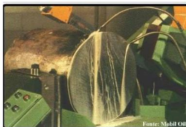
Imagem 4.1 - Fluído de corte na maquinagem.
