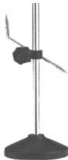
Fig 30 - Graminho simples - utilizado na traçagem em diversas situações.
