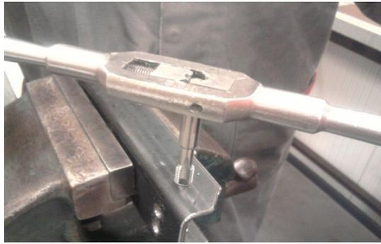
Fig. 69 - Abertura da rosca com ajuda de um macho de 8mm
