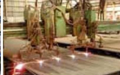
Fig 61- corte múltiplo à máquina
