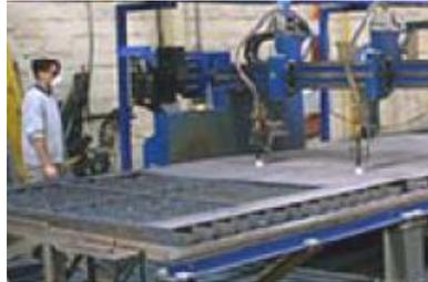
Fig 60- corte duplo à máquina
