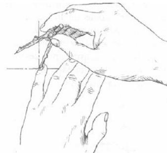
Use o dedo mínimo como guia para posicionar a ponta metálica na posição de centro.
